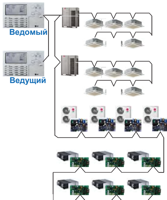
Правильное подключение кабеля
