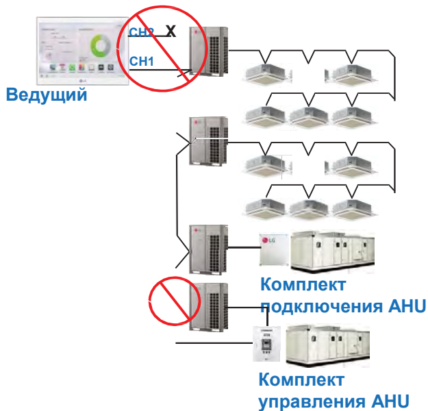
Неправильное подключение кабеля
