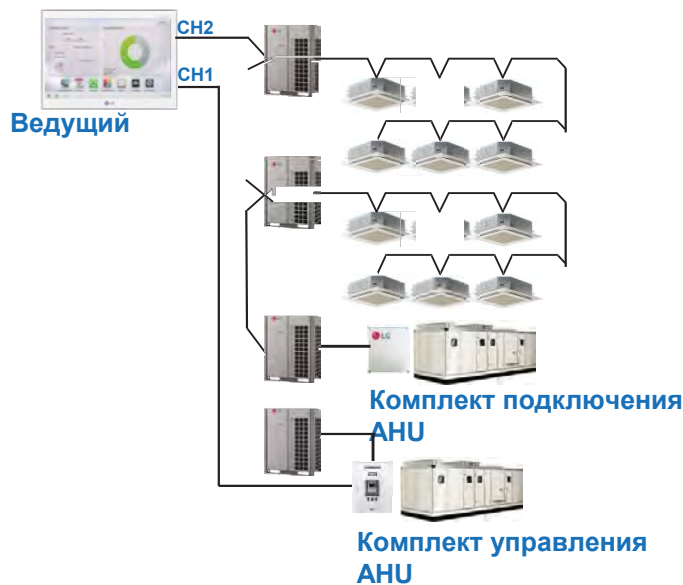
Правильное подключение кабеля
