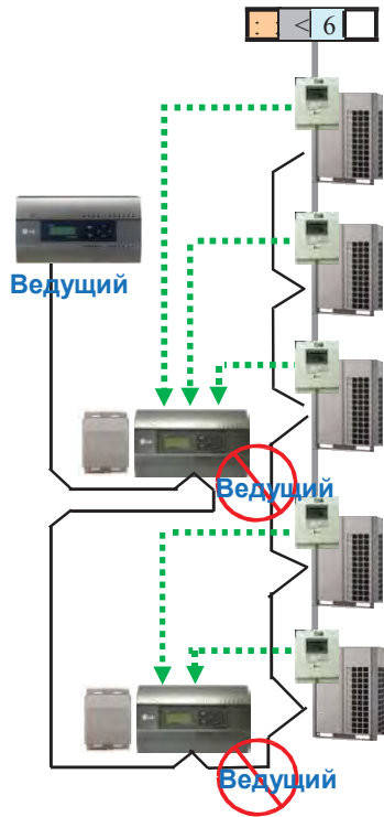
Неправильное подключение кабеля
